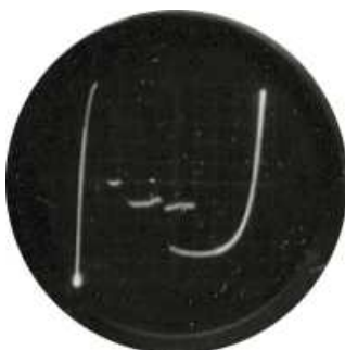
試作 Ge エサキダイオード - 特性試験
